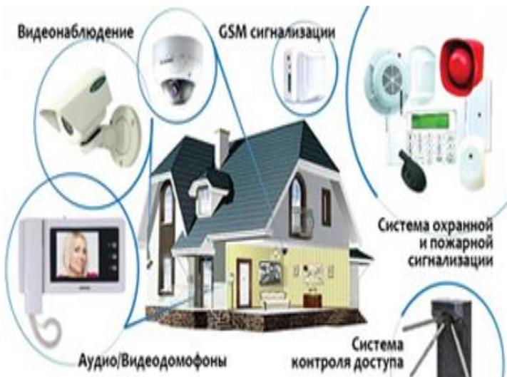
Система пожарной сигнализации — совокупность технических средств, предназначенных для обнаружения факторов пожара, формирования, сбора, обработки, регистрации и передачи в заданном виде сигналов о пожаре, режимах работы системы, другой информации и, при необходимости, выдачи сигналов на управление техническими средствами противопожарной защиты, технологическим, электротехническим и другим оборудованием.
